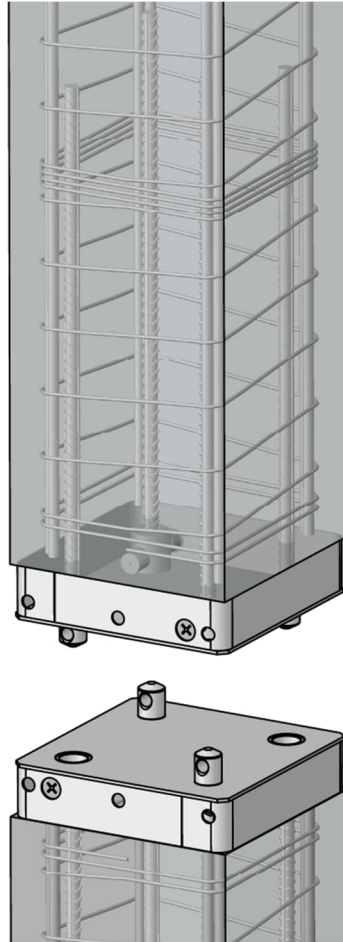
Figur 6.28 Illustration – Vanlig utformning av skarv för betongpåle.
