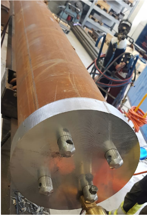
Figur 3.32 Exempel på stålpåle med en monterad betongpåleskarv.
