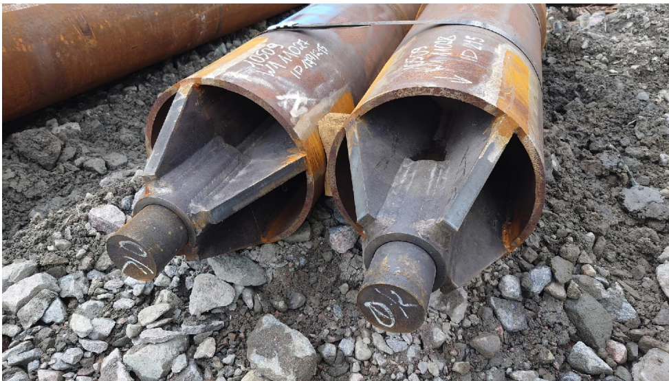
Figur 3.25 Stålrörspåle med öppen bergsko, s.k. "Hullspiss", försedd med härdad bergdubb.
