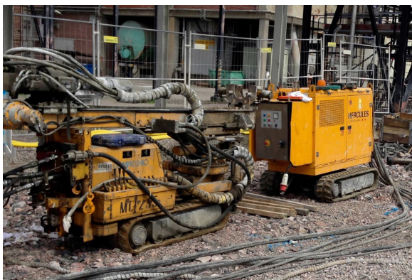
Figur 3.35 Källarmus (Geomek med separat kraftpaket) som kan borra foderrör för stålkärnepålar eller stålålar i trånga utrymmen.
