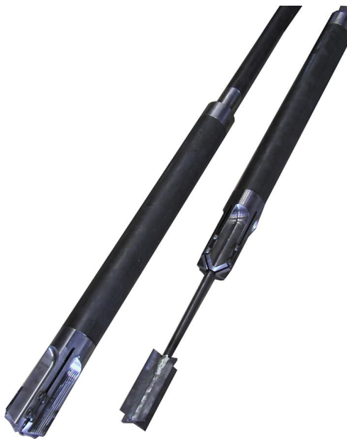
Figur 2.5 Vinginstrument EVT 2000 med skyddssko för vinge och ett skyddande rör runt förlängningsstängerna (Foto: Geotech).
